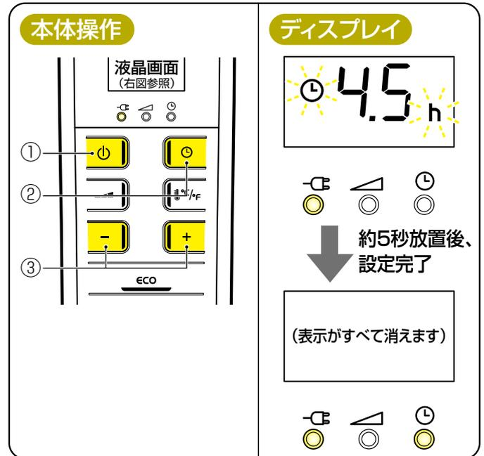
**ヒント** ディスプレイの 🕒 および h が点滅している間（約 5 秒）にタイマー設定ボタンを操作した場合、タイマーは設定されません。タイマー設定後は必ずタイマー予約設定ランプが点灯していることを確認してください。
