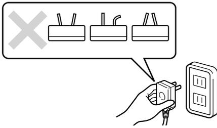
曲がった栓刃は、接触不良時の発熱により、コンセントの刃受を変形させる原因となります。
