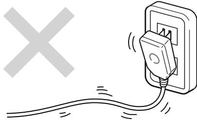
刃受のばね圧力が劣化したコンセントを使用すると、電源プラグと十分な接触が得られず異常発熱し、発火の原因となります。
