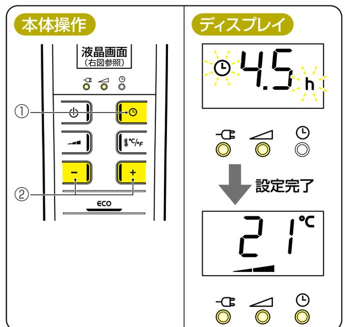
**ヒント** タイマー予約設定ランプが点灯するとタイマー予約完了です。タイマー予約設定ランプが点灯していない場合は、再度タイマー設定予約ボタンを押し、約 5 秒後にタイマー予約設定ランプが点灯していることを確認してください。
