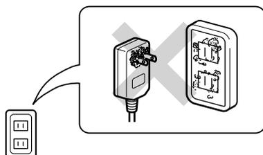
電源プラグとコンセントの接触面にホコリや湿気が付着すると、トラッキング現象が発生し、発火の原因になります。
