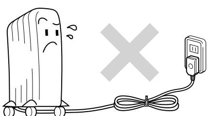
ヒーター運転中は電源コードの温度が人の体温程度（約40°C）になります。電源コードを束ねたままでお使いになると、熱の逃げ場がなくなり、異常発熱し発火の原因になります。
