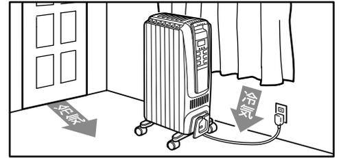
室内で、特に冷気のダウンドラフト(冷気の侵入)が発生しやすい場所＝窓の下や外気に触れている壁際などに設置してください。ヒーターの暖気による“エアカーテン”で、ダウンドラフトの発生を抑えます。また、窓に厚手のカーテンをしたり、ドアの開閉頻度を減らすなどの工夫をすることで、より効果的な暖房が得られます。
