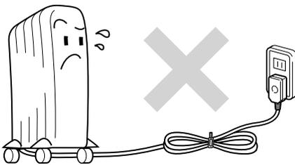
ヒーター運転中は電源コードの温度が人の体温程度（約 40℃）になります。電源コードを束ねたままでお使いになると、熱の逃げ場がなくなり、異常発熱し発火の原因になります。
