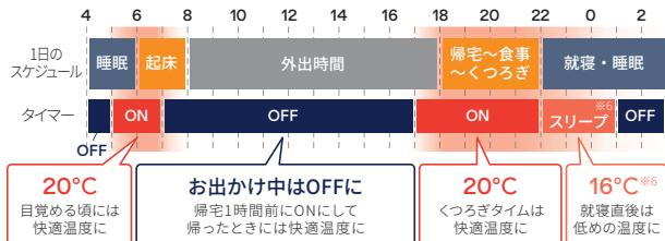
※6 マルチダイナミックヒーター Wi-Fiモデルには就寝時の温度を設定できるスリープモードを搭載しています。
